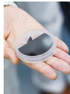
結晶成長によって作られたGaAsの結晶。
