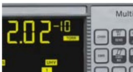
結晶成長の実験装置。-10と表示された数値は、装置内が通常の大気圧より10乗倍の超高真空であることを示している。
